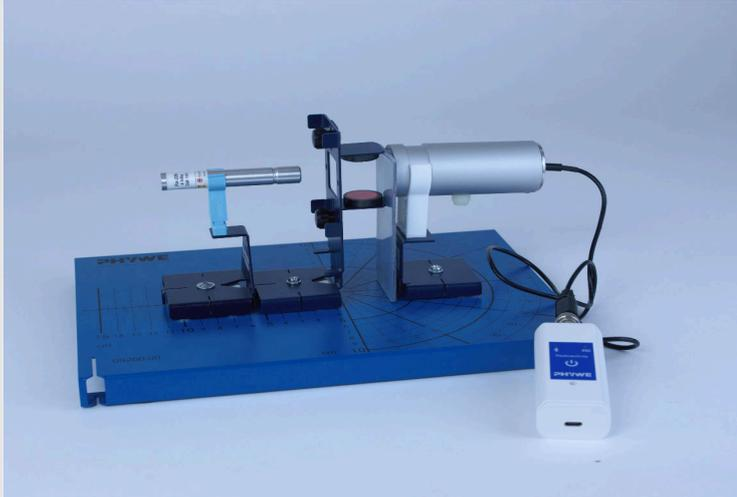
Экспериментальная установка с установленной свинцовой пластиной
